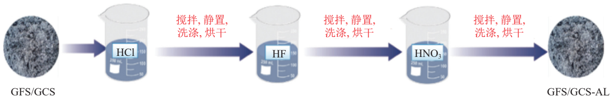
图 1 样品酸处理过程示意
