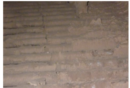
图4 生物质锅炉受热面沾污
