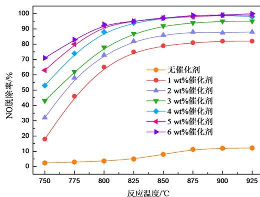
图 3 催化剂填装量对 NO 脱除率的影响
