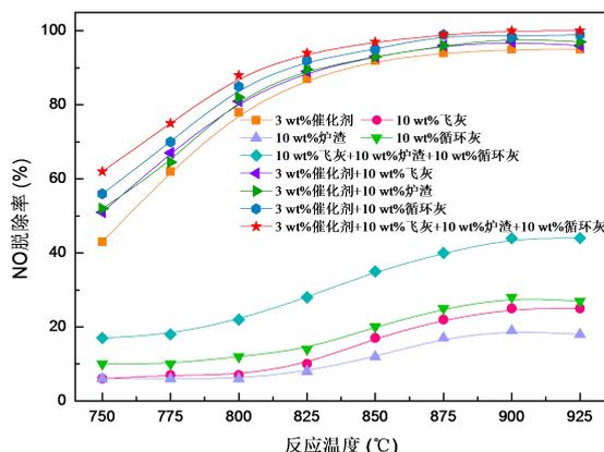
图 4 床料对 NO 脱除率的影响
