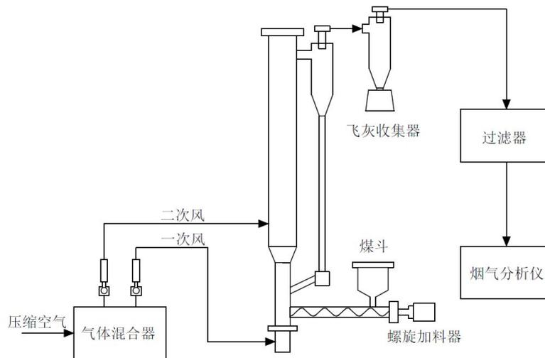
图 2 CFB 锅炉中试装置示意图
