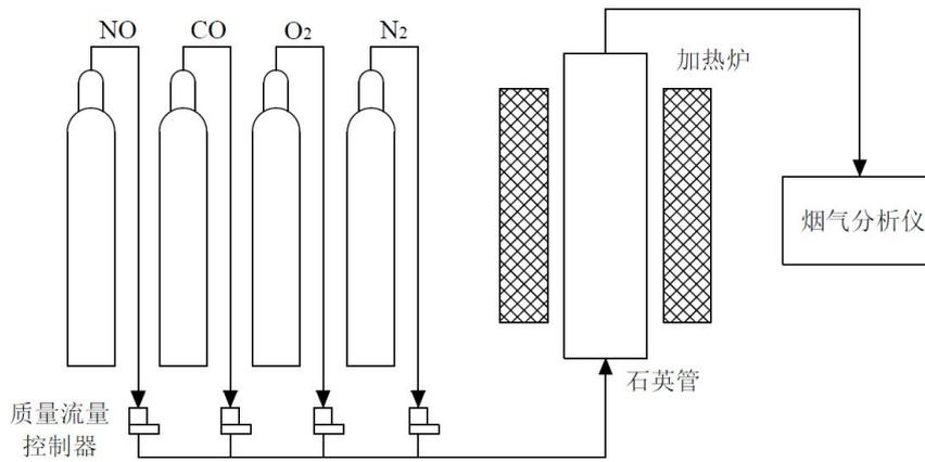
图 1 固定床反应器试验装置示意图
