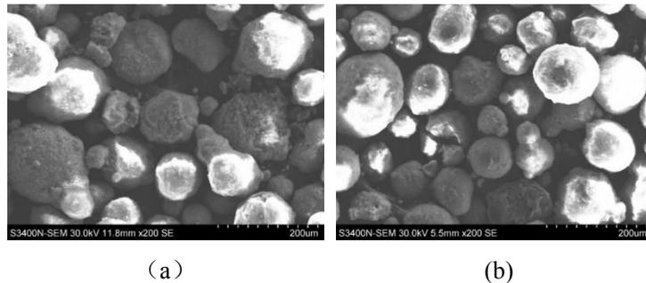
图 5 脱硝催化剂表面形态 (a.反应前; b.反应后)
