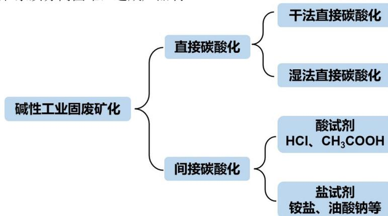
图4 碱性固废矿化技术路线图<sup>[32]</sup>
