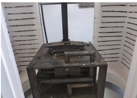
(a) 5层电堆的试验装置
