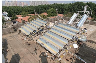
(d) 基于CPC反应器的光催化制氢系统<sup>[64]</sup>
