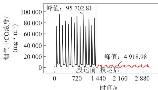
图6 烟气反吹系统投运减排效果
