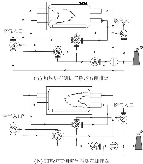
图1 蓄热式加热炉工作原理
