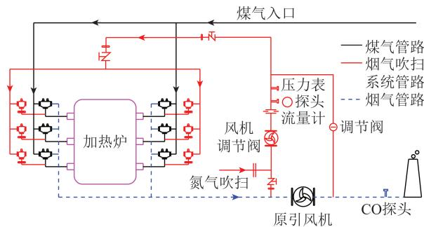
图3 管道残留煤气部位示意
