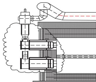
图2 管道残留煤气部位示意
