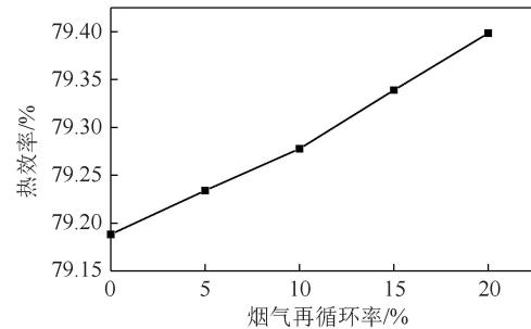
图8 烟气再循环率对热效率的影响(工况0、3~6)
