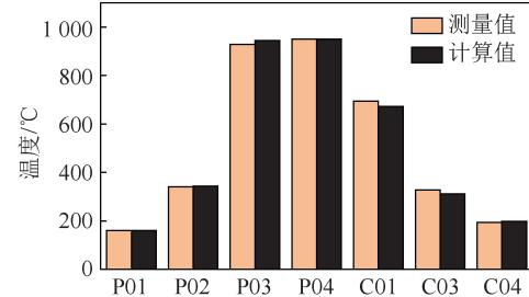
图 5 低负荷下各设备的温度的测量值和计算值对比
