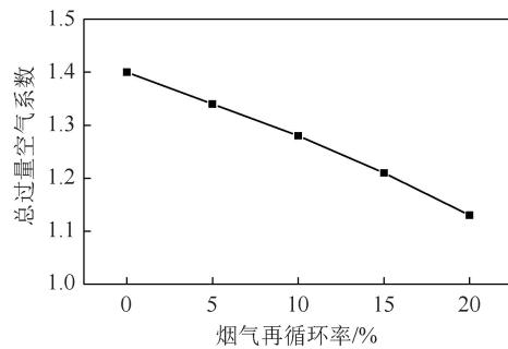
图6 烟气再循环率对焙烧炉系统总过量空气系数的影响(工况0、3~6)
