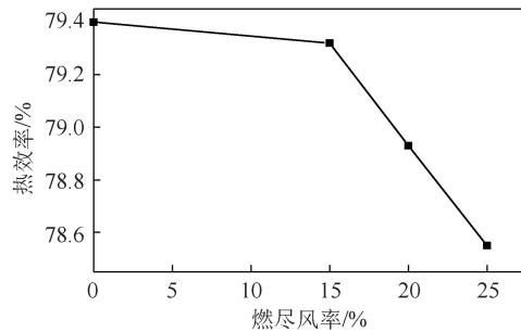
图10 燃尽风率对热效率的影响(工况6~9)
