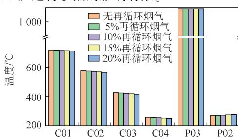
图7 烟气再循环率对各设备温度的影响(工况0、3~6)
