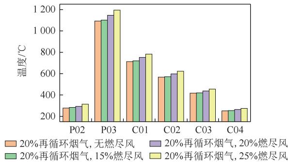
图9 燃尽风率对各设备温度的影响(工况6~9)
