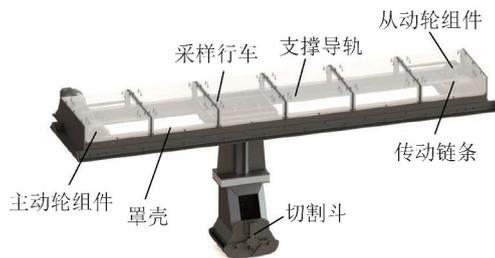
图3 胶带端部初级采样器模型
