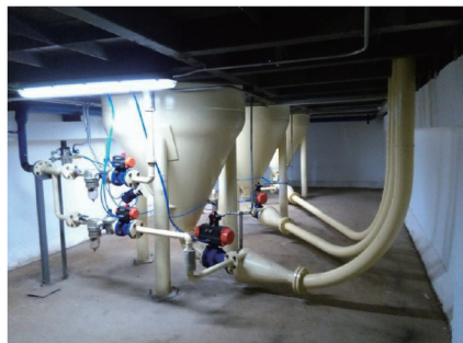
图4 气力输送装置
