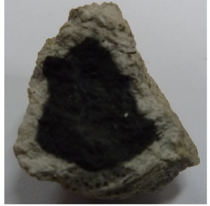
图 1 煤矸石燃烧形成灰壳结构
