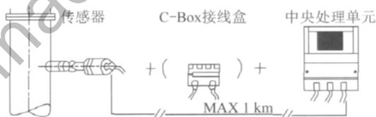
图4 微波固体测量系统组成
