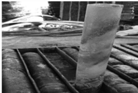
图 1 粗晶结构块状岩盐(NaCl 质量分数 98.68%)
