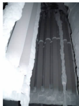
图 5 运行 11 个月后的金属滤芯
