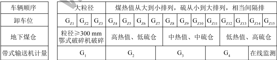
图 8 基于无筒仓的混配系统
