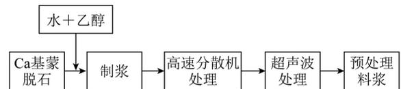
图 2 钙基蒙脱石预处理流程
