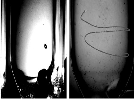
图6 高速动态显微摄像机拍摄气泡在不同时刻的位置
